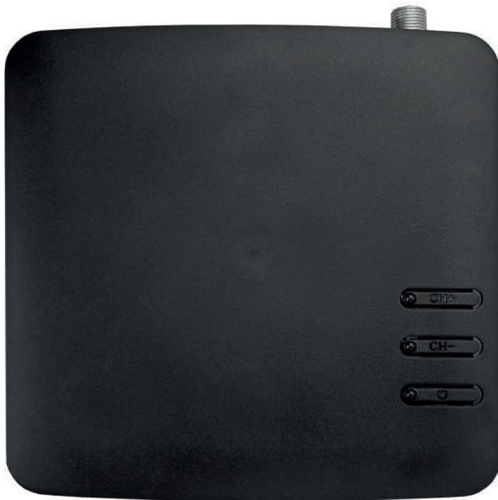
На верхней панели размещены: кнопка включения/выключения приставки и кнопки переключения каналов.
